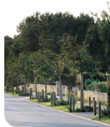
Pour réduire les surfaces imperméables, les stationnements en long sont en gazon renforcé.
